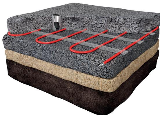
Instalación en asfalto
