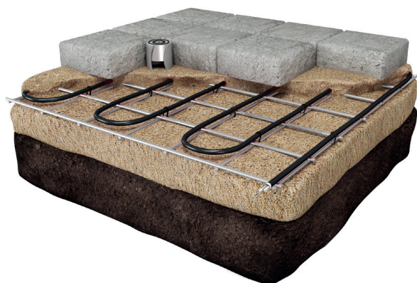
Instalación bajo adoquines
