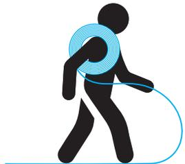
La tubería se suministra en rollo y por lo tanto está bajo tensión. Para evitar que ésta se levante al entrar en las ranuras, debe desenrollarlo en la dirección opuesta (ver imagen). Con este método eliminará en gran medida esta tensión.
